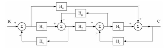
$$TF = \frac{H_1H_2H_3 + H_4[1 - H_2H_6]}{1 - [H_1H_5 + H_3H_7 + H_2H_6 + H_4H_5H_6H_7] + [H_1H_3H_5H_7]}$$
